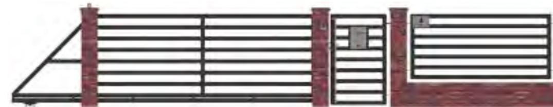
Les travées montées sur la fondation, attachées aux poteaux de brique.
