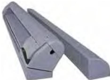
Cet aérateur utile et recommandé se caractérise par la possibilité de diriger le flux d'air verticalement, vers le haut, ou obliquement. Grâce au capteur de régulation sous la forme d'une bande de polyamide, il est possible de bloquer la position de l'entrée d'air sans régulation manuelle. Le réglage du débit d'air dépend du taux d'humidité de l'air intérieur. Une alimentation électrique n'est pas nécessaire.
