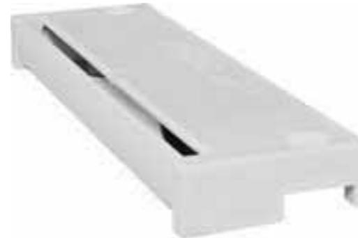
Il s'agit d'une entrée d'air à fente en deux éléments. Sa technologie de fabrication offre un débit d'air contrôlé. Il permet de diminuer le taux d'humidité dans une pièce où son niveau est déjà très élevé. Il est doté d'un système automatique de régulation dans le cas d'un changement de pression exercé par le vent.
